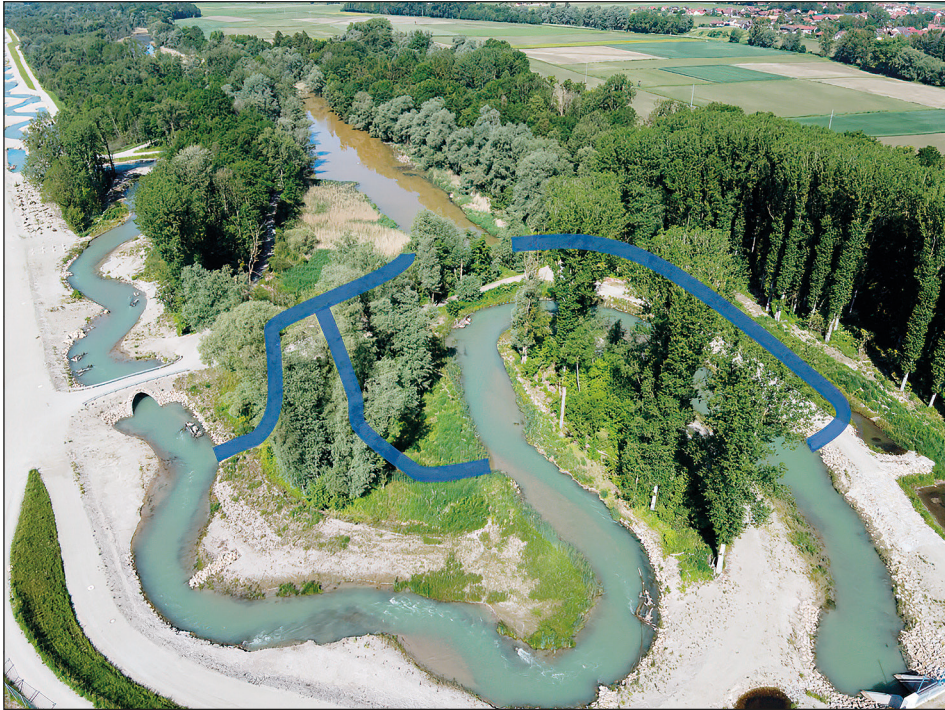
Abb. 6: Das neugeschaffene, dynamisch dotierte Umgehungsgerinne Ering/Inn (Bildvordergrund) kann über drei Verbindungskanäle (hervorgehoben durch blaue Linien) mit dem Eringer Altwasser (Bildhintergrund) verbunden werden. Je nachdem welcher der drei Verbindungskanäle geöffnet ist, stellt sich im Altwasser ein hoher, mittlerer oder niedriger Wasserstand ein. Die so erzielten jahreszeitlichen Wasserstandsschwankungen betragen im Altwasser ca. 1,5 m und erzeugen großflächige wechselfeuchte Uferzonen. – Fig. 6: The newly created, dynamically flooded bypass channel Ering/Inn (foreground) can be connected to the oxbow-lake Ering (background) via three channels (highlighted by blue lines). Depending on which of the three channels is open, the water level in the oxbow lake is high, medium or low. The seasonal water level fluctuations achieved in the oxbow lake amount to approx. 1.5 m and create large-scale alternating wet bank zones.
